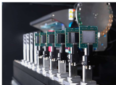
自動進樣裝置可在無人值守的情況下操作設備，一次掃描多個樣品，連續掃描多日。
